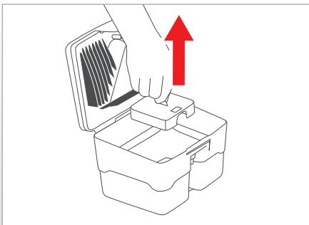
Sofern sich noch Schmutz im Schmutzwasserbehälter der AQUA-Pure-Filterbox befindet, reinigen Sie diesen gründlich unter fließendem Wasser und gießen das Schmutzwasser über die Ausgieöffnung aus.
