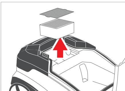
**Spezial-Hygiene-FILTER HEPA13 und Vorfilter reinigen**
