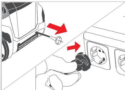
Greifen Sie das Netzanschlusskabel am Netzstecker.
