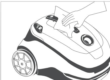
**Gehäuse des Gerätes reinigen**
