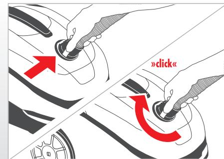
**Czyszczenie podłogi****Połączyc rurę teleskopową z uchwytem węża ssącego.**
