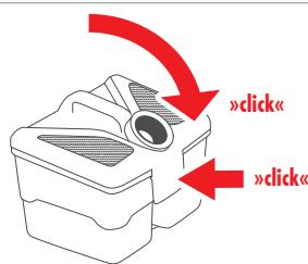
**Schließen Sie den Deckel der AQUA-Pure-Filterbox.**
