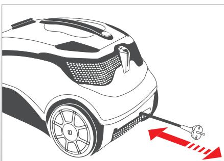
Ziehen Sie den Netzstecker aus der Steckdose. Ziehen Sie das Netzanchlusskabel mit leichtem Zug vom Gerät weg und lassen Sie es los. Das Kabel rollt sich dann automatisch auf.
