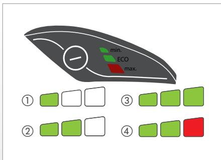
Schalten Sie das Gerät durch Drücken der Starttaste am Gerät oder an der Funkfernbedienung\* ein. Das Gerät startet im Eco-Modus, was durch das Leuchten von zwei grünen Anzeigebalken angezeigt wird.
